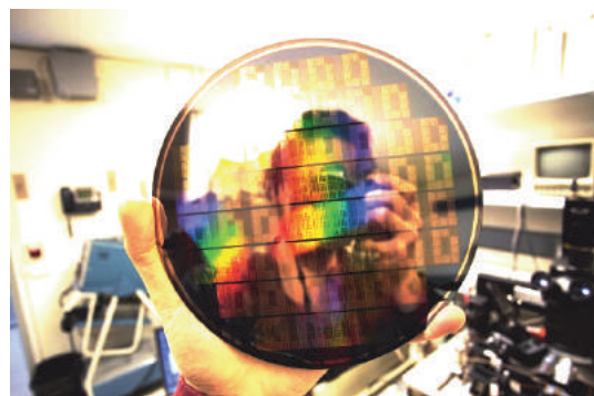
Làmina de silici i grafè de 200mm de diàmetre
