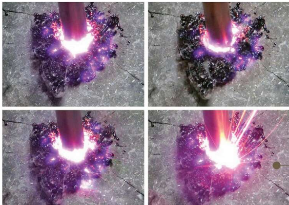
Prova de perforació de roca amb microones. Imatge JPT / Quaise
