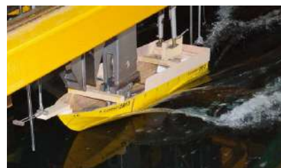
Il·lustració 41: Carro remolcador, Canal Experiències Hidrodinàmiques del Pardo, Madrid.
