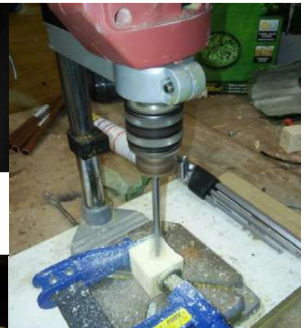
Fig52: Taladre foradant el tac de fusta/ Font pròpia
