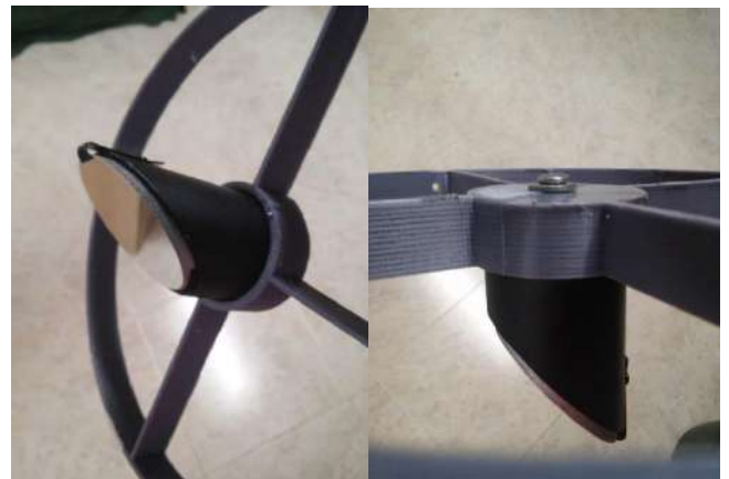
Fig38/39: Mirall secundari i aranya/ Font pròpia
