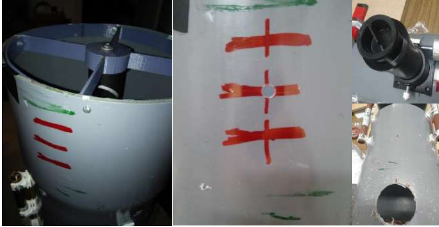
Fig45/Fig46: Marques per fer el forat per l'enfocador/Font pròpia
